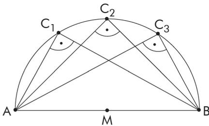
Verbindet man die Punkte  $C_n$  des Halbkreises über einer Mittelsehne mit den Endpunkten A und B, so haben die Winkel  $AC_nB$  das Maß  $90^\circ$ .
